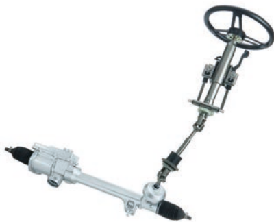
Imagen 66. Columna de dirección articulada
