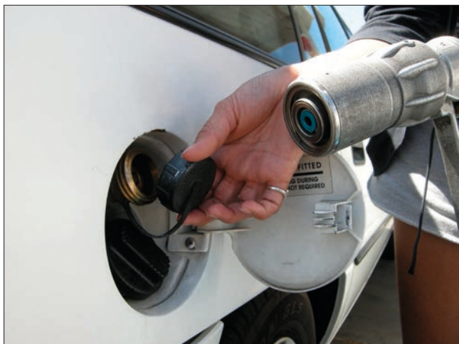
Imagen 34. Tapa de llenado con depósito de gas
