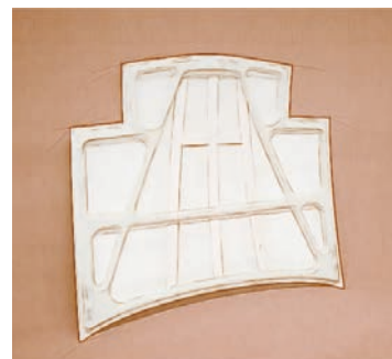
Imagen 61. Refuerzos interiores del capó
