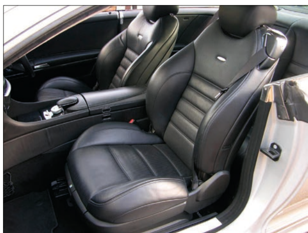
Imagen 79. Sistema de cinturón integrado en el asiento
