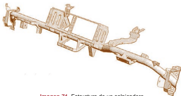
Imagen 71. Estructura de un salpicadero
