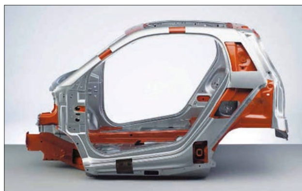
Imagen 24. Partes de la carrocería de chasis independiente
