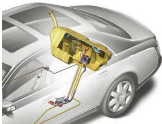
Imagen 67. Emplazamiento de depósito de combustible
