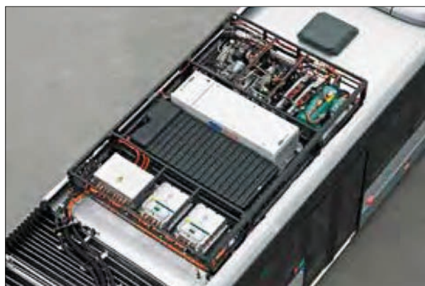
Imagen 42. Grupos auxiliares de accionamiento eléctrico y baterías
