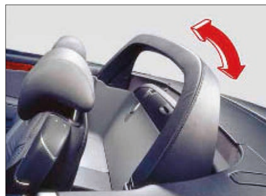
Imagen 70. Arco protector integrado en la estructura
