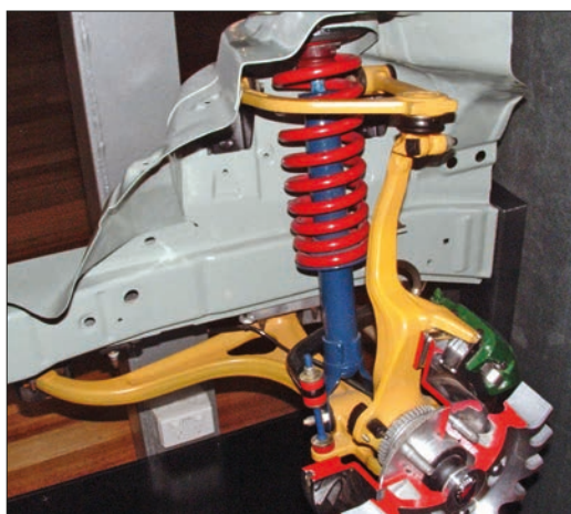
Imagen 48. Amortiguador tipo McPherson
